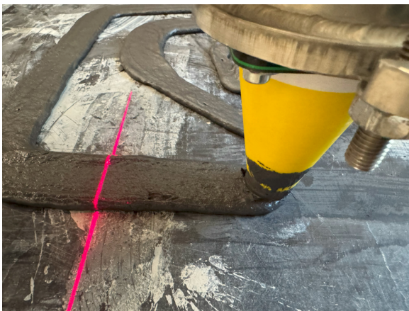
(b) Projekce čáry na tištěnou vrstvu
