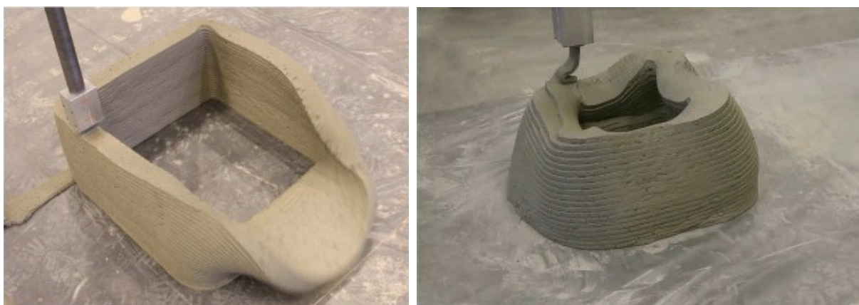
Obrázek 1: Příklady vad při tisku betonu - kolaps stěn výtisku[3]
