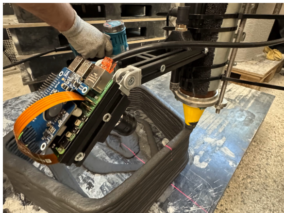
(a) Umístění zařízení na tiskové hlavě
